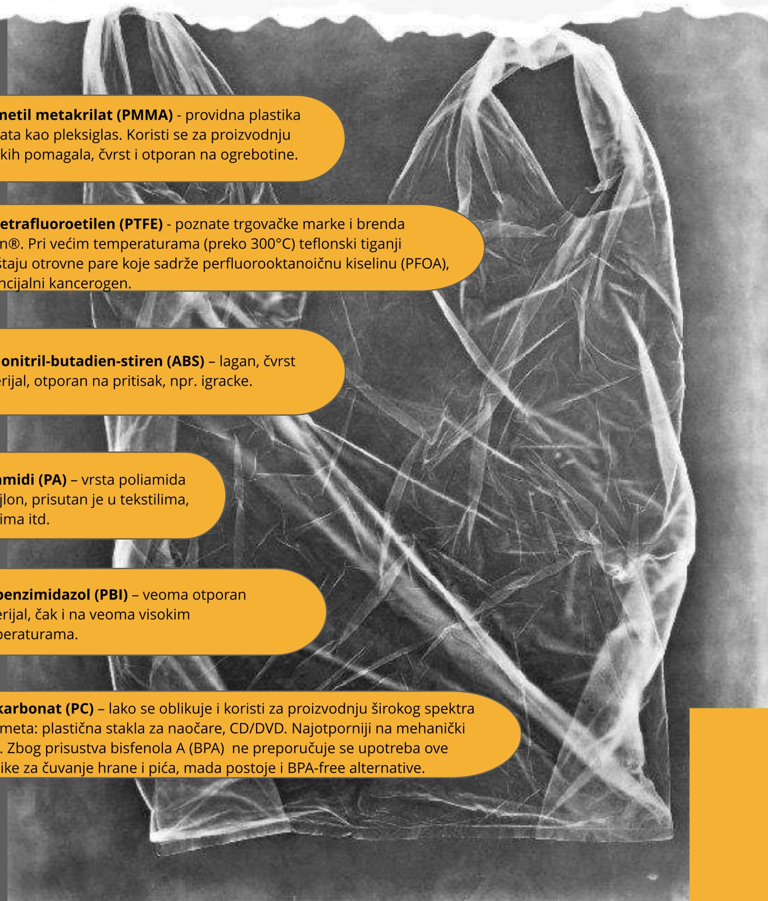
**Polimetil metakrilat (PMMA)** - providna plastika poznata kao pleksiglas. Koristi se za proizvodnju optičkih pomagala, čvrst i otporan na ogrebotine.
